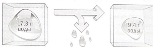
7,9 г воды выпадают в виде конденсата
